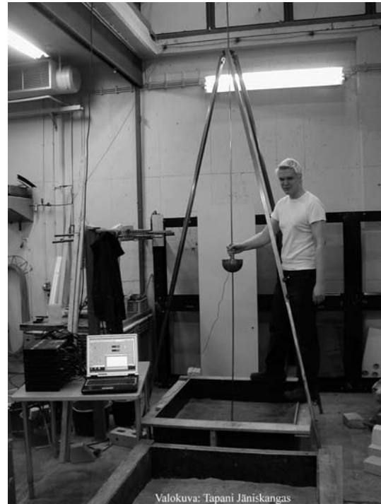
KUVA 2. Pudotustesti testattavalle turvahiekalle
