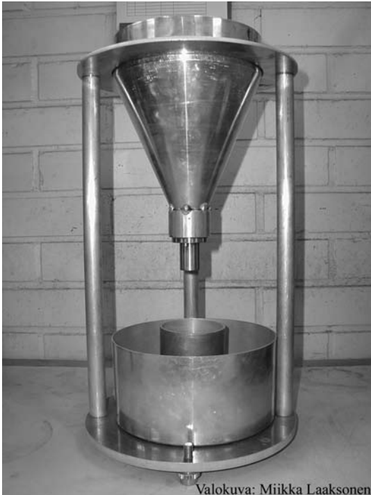
KUVA 1. Sand Flow Cone -laitteisto
