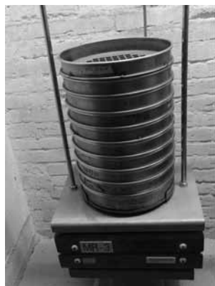
KUVA 1. Seulonnassa käytettävä standardiseulasarja ja seulatärytin sekä laserdiffraktio -laitteisto
